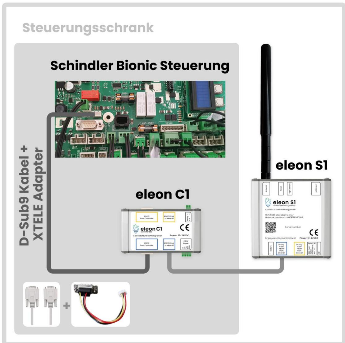
**11.** Schalten Sie die Stromversorgung der Steuerung ein. Das **eleon S1** startet automatisch.
