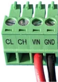
5. Schließen Sie das Stromkabel mit dem grünen Stecker an das **eleon C1** an. Vin: 12-24 VDC, GND: an den Erdungsanschluss.
