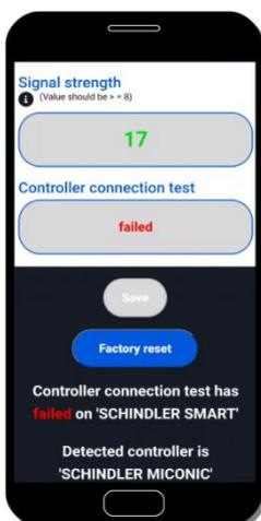
3.4.1. Überprüfen Sie, ob die richtige Steuerung für die entsprechende Steuerung ausgewählt wurde.
