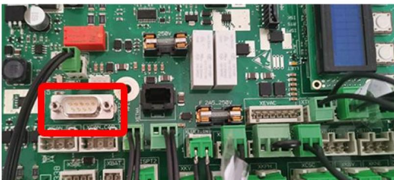
9. Verwenden Sie das D-Sub9-Kabel, um die CPU-Platine mit dem blau gekennzeichneten **eleon C1**-Steckplatz (RS232 von der Steuerung) zu verbinden.
