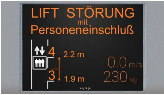
Abbildung 1: Vernetzte TFT-Displays im Aufzug ermöglichen die Darstellung von Lift- und Sensordaten zusammen mit Gebäudeinformationen und Werbung.
