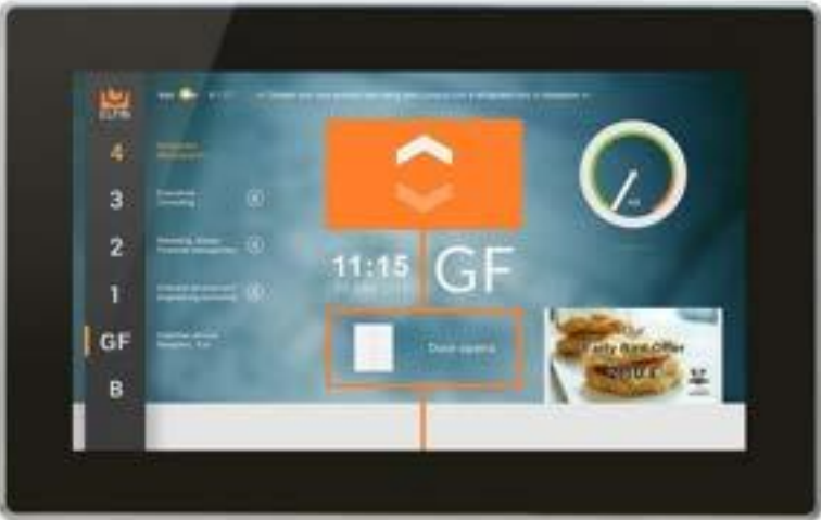
Abb.: Darstellung der aktuellen Last in der Kabine in Form eines analogen Zeigerinstrumentes ohne Darstellung der konkreten Messwerte.
