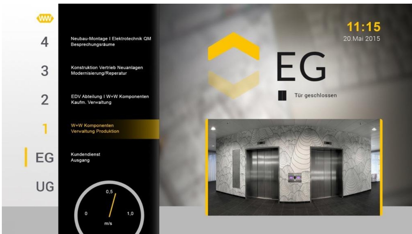
Abb. 2: Darstellung von Position und Last im Störfall auf einem Display im Hauptzugang eines Aufzugs.
