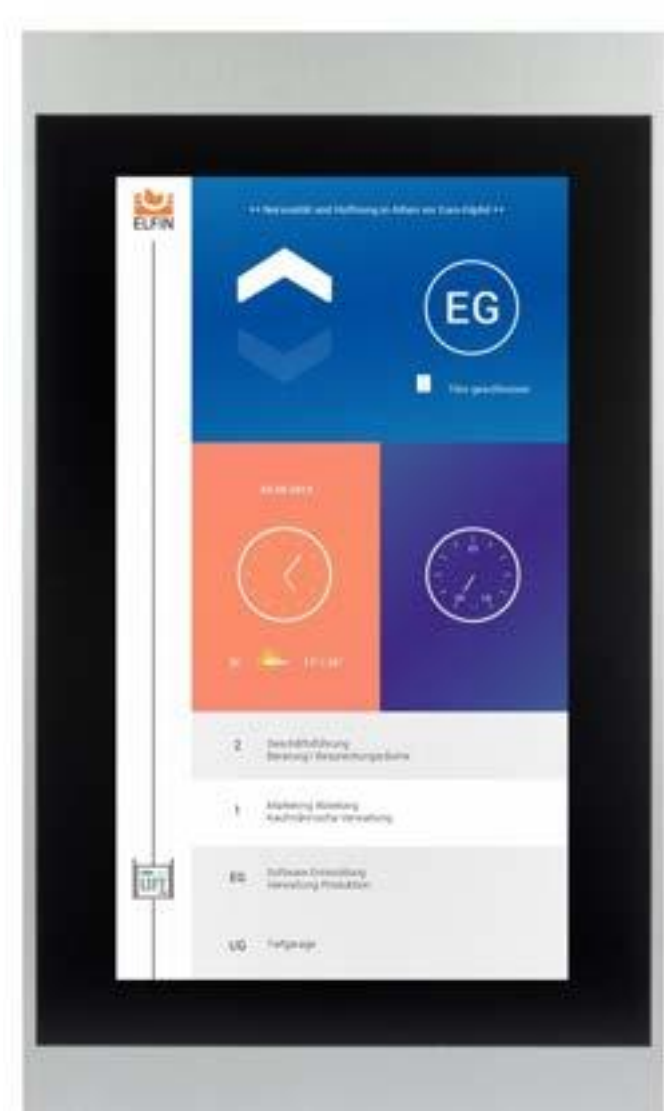
Abb. 6: Maßstabgerechte Darstellung der Position im Schacht (links) und Darstellung der Geschwindigkeit als Zeigerinstrument in Kombination mit Gebäude-, Lift- und Internet-Informationen.
