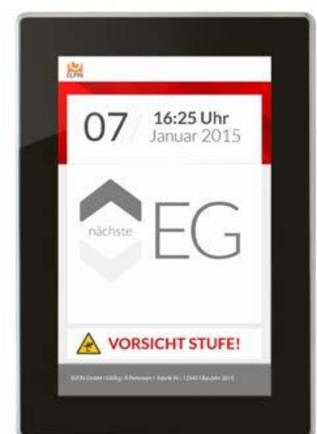
Abb. 4: Warnung "Vorsicht Stufe!" auf dem Display in einer Aufzugskabine.
